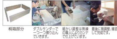
桐部材加工 矩形組み手接ぎの接合前 矩形組み手接ぎの接合後 最後に前板を取りつけて完成です
